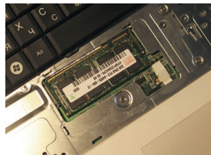
Оказалось, что злодей-сисадмин поленился проверить скрытые разъемы, «забыв» снять 2-Гбайт модуль памяти, размещенный под клавиатурой
