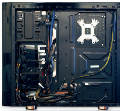
Правильная укладка кабелей обеспечивает хорошую вентиляцию и четкий обзор
