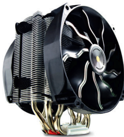
Массивный радиатор Xigmatek Prime SD1484 позволяет снизить уровень шума
